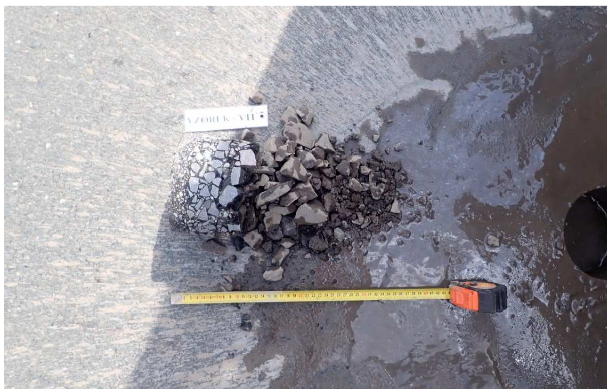
Obr. 21- Jádru vývrtu Vzorek – V11 (in situ).
