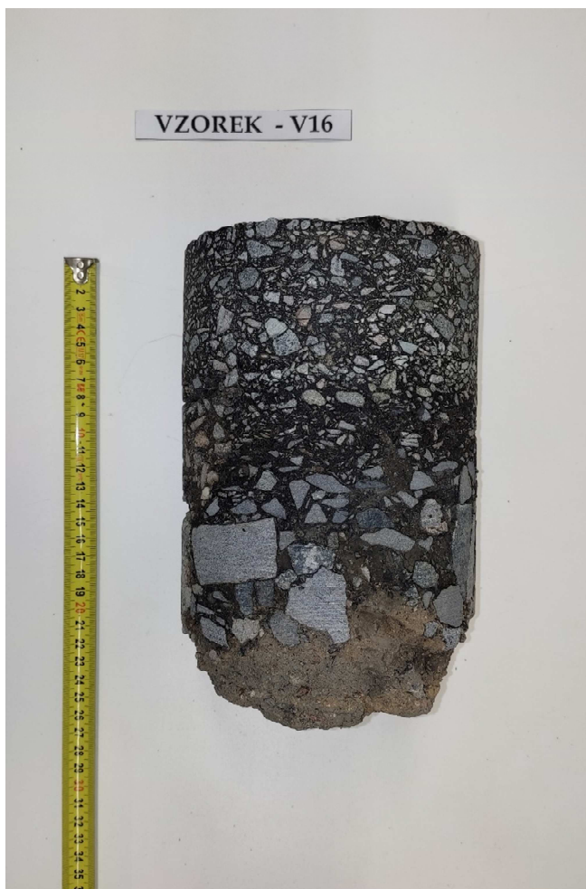
Obr. 32 - Jádru vývrtu Vzorek – V16 (laboratoř).
