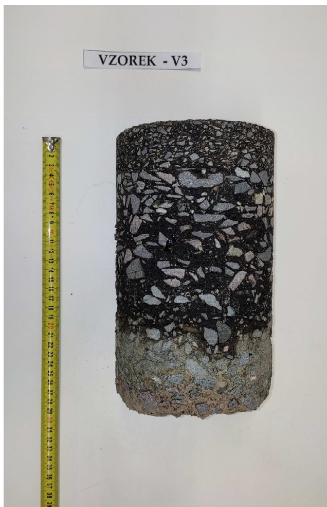
Obr. 6 - Jádru vývrtu Vzorek – V3 (laboratoř).
