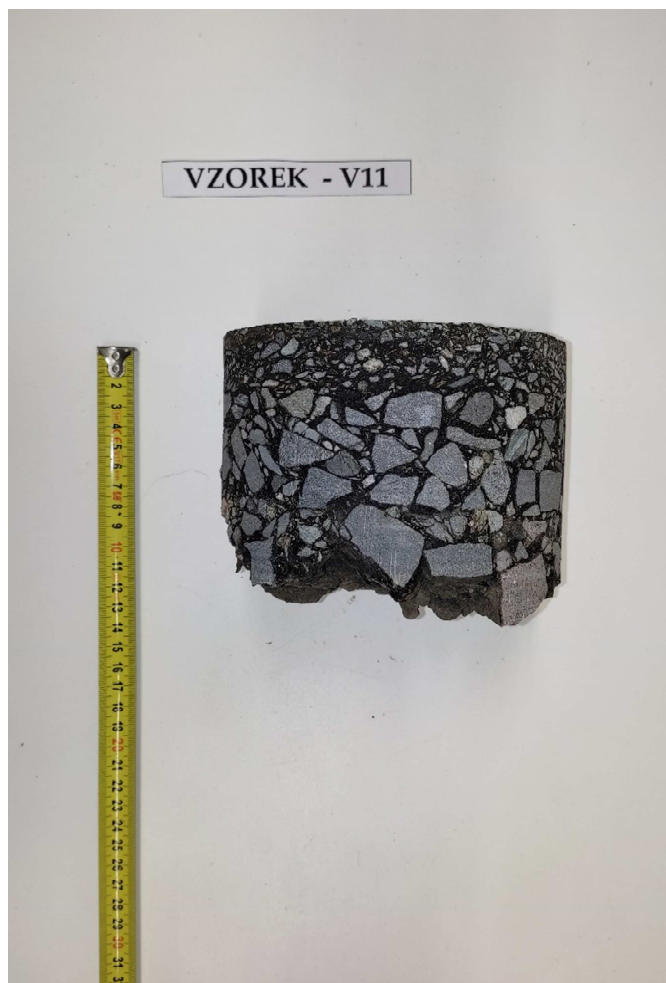
Obr. 22 - Jádru vývrtu Vzorek – V11 (laboratoř).
