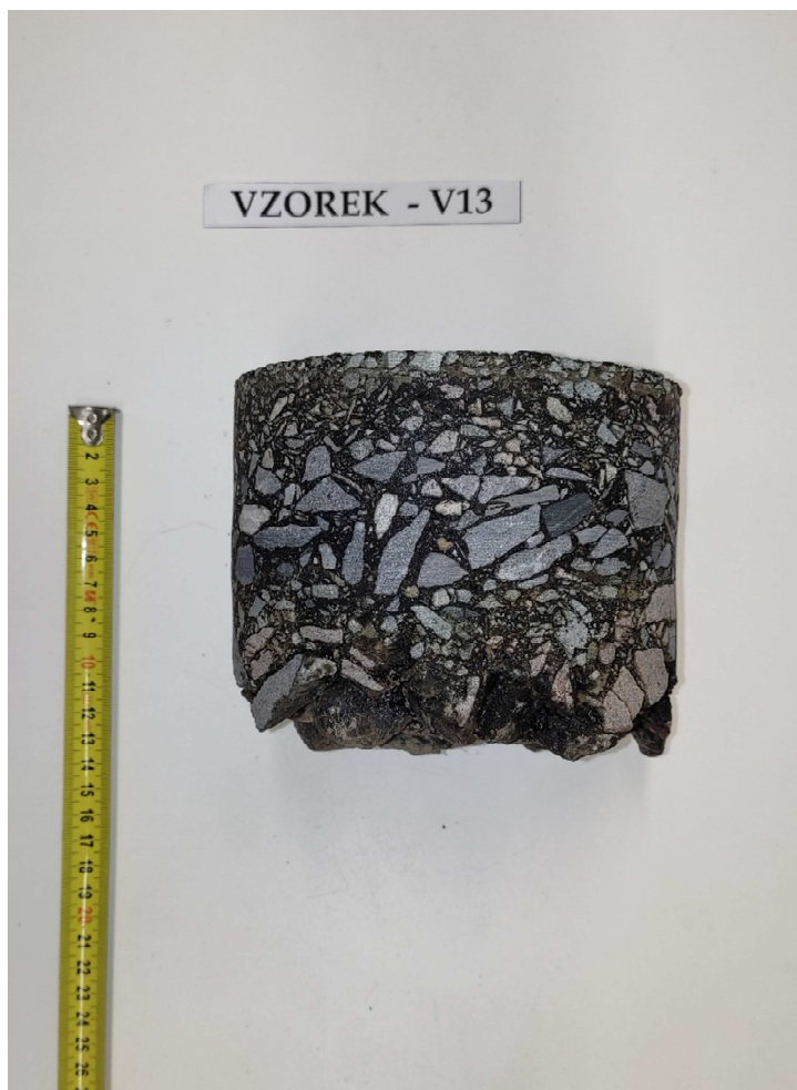
Obr. 26 - Jádru vývrtu Vzorek – V13 (laboratoř).
