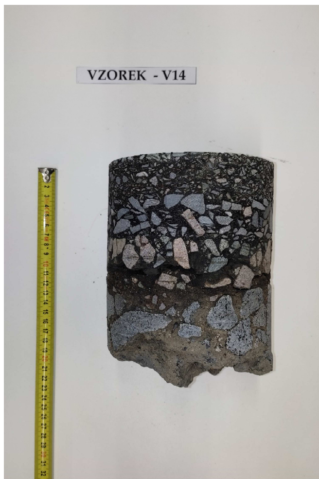
Obr. 28 - Jádru vývrtu Vzorek – V14 (laboratoř).
