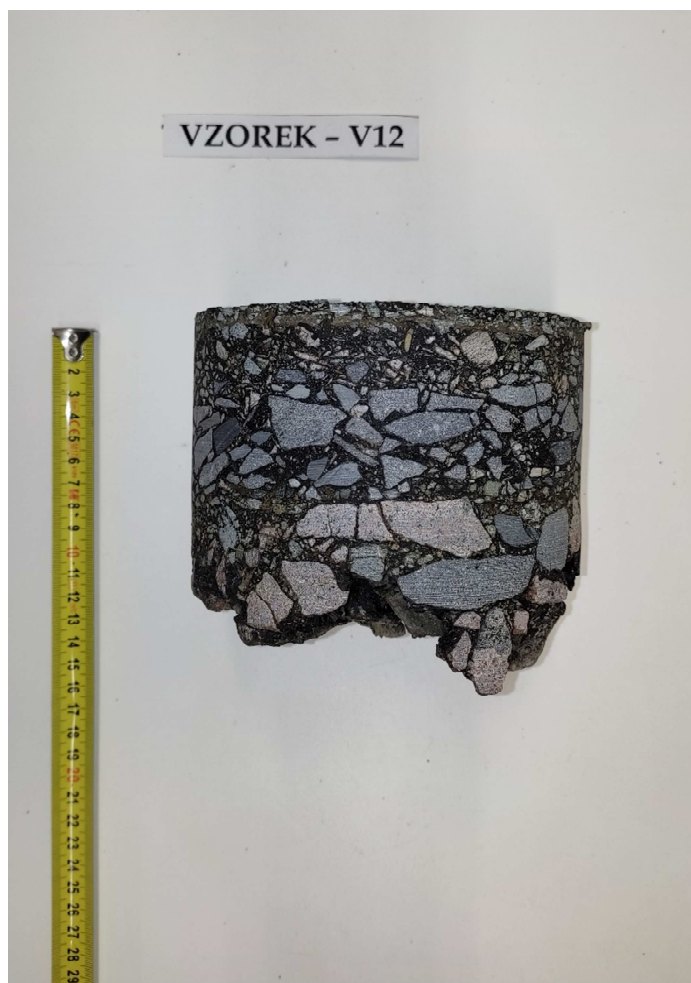
Obr. 24 Jádro vývrtu Vzorek – V12 (laboratoř).
