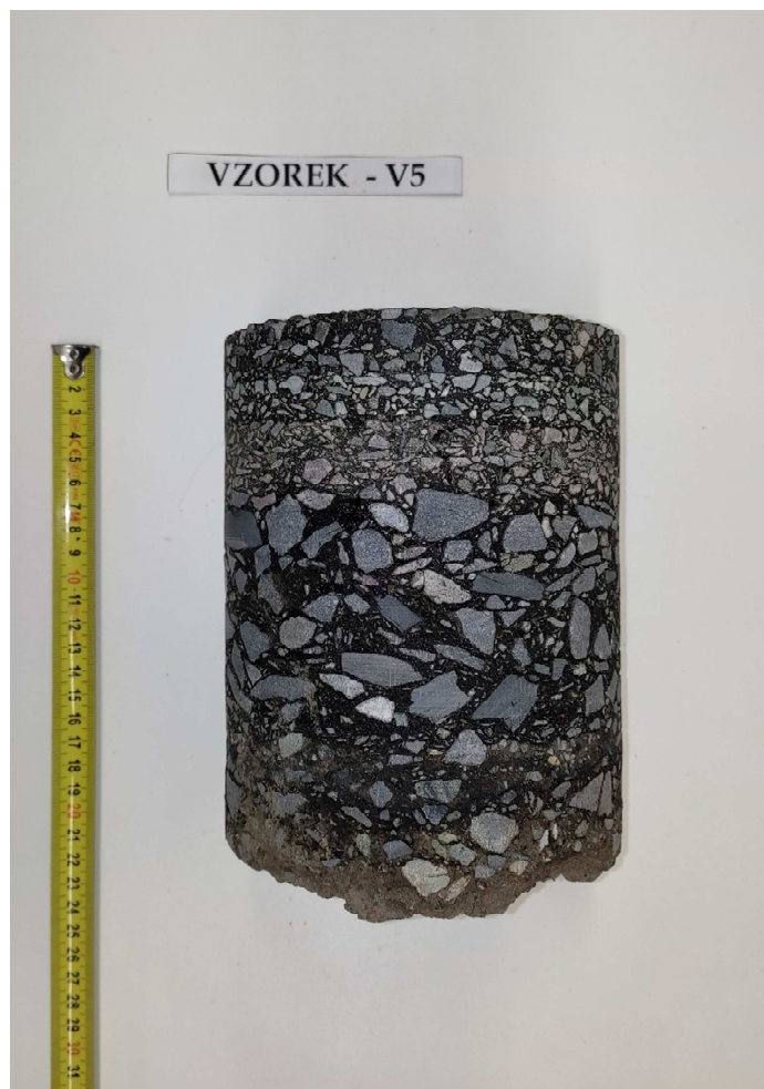
Obr. 10 - Jádro vývrtu Vzorek – V5 (laboratoř).
