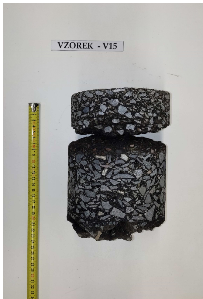
Obr. 30 - Jádru vývrtu Vzorek – V15 (laboratoř).
