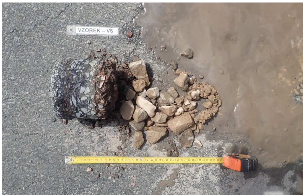
Obr. 11 - Jádro vývrtu Vzorek – V6 (in situ).
