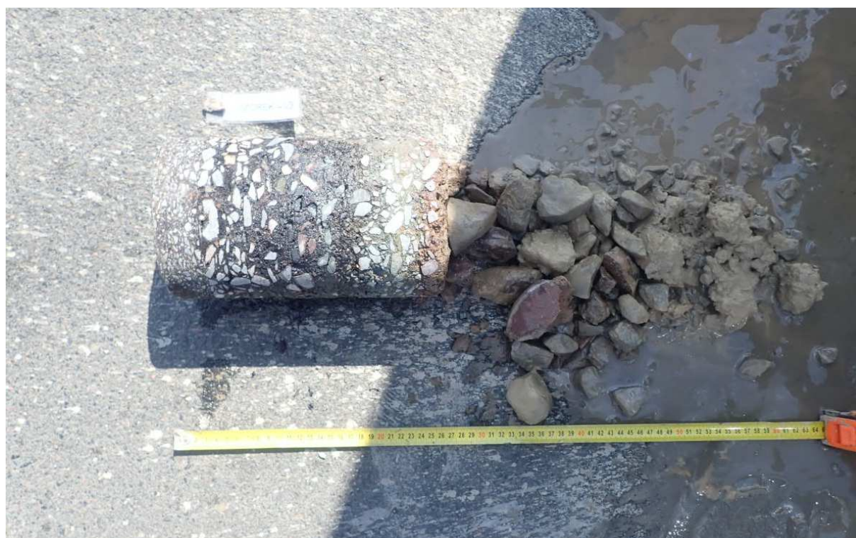
Obr. 5 - Jádro vývrtu Vzorek – V3 (in situ).
