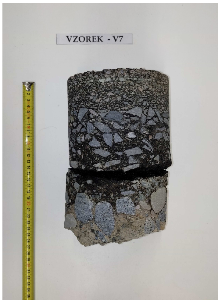
Obr. 14 - Jádro vývrtu Vzorek – V7 (laboratoř).
