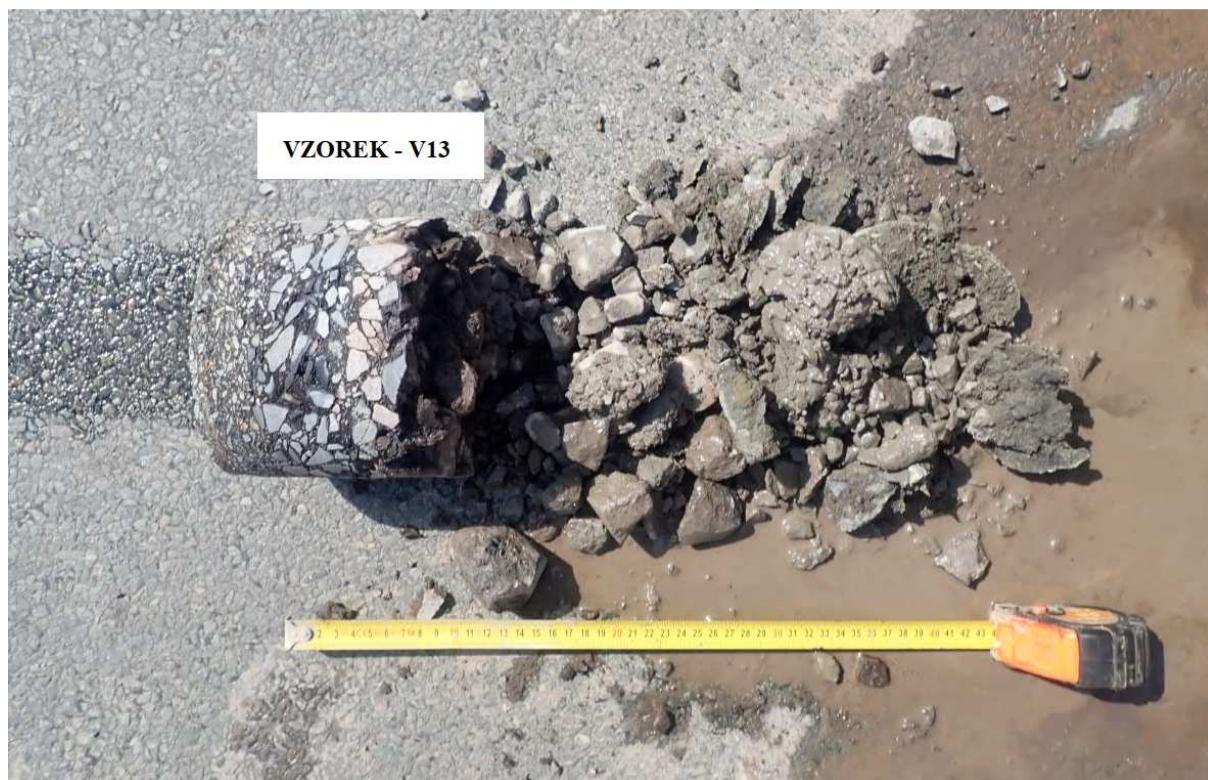
Obr. 25 - Jádru vývrtu Vzorek – V13 (in situ).
