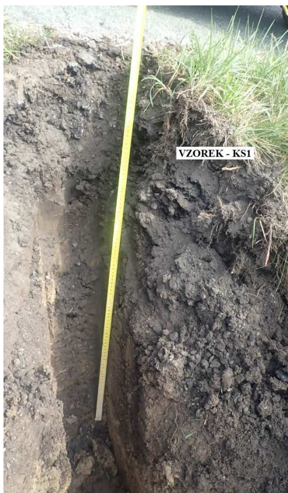
Obr. 33 - Jádru vývrtu Vzorek – KS1 (in situ).
