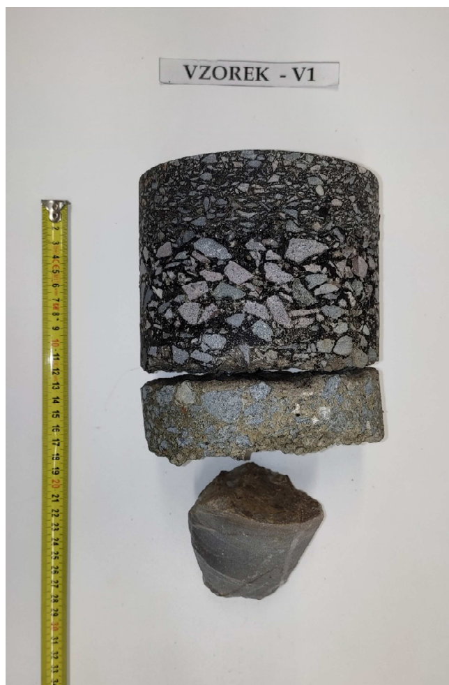
Obr. 2 - Jádru vývrtu Vzorek – V1 (laboratoř).
