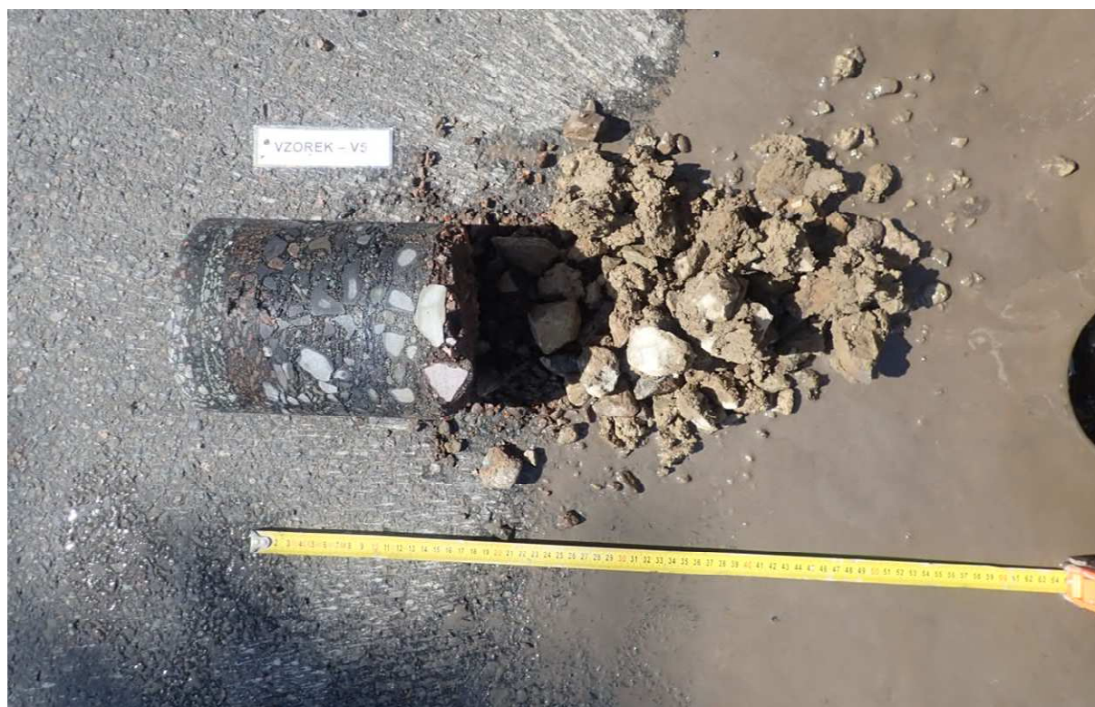
Obr. 9- Jádro vývrtu Vzorek – V5 (in situ).
