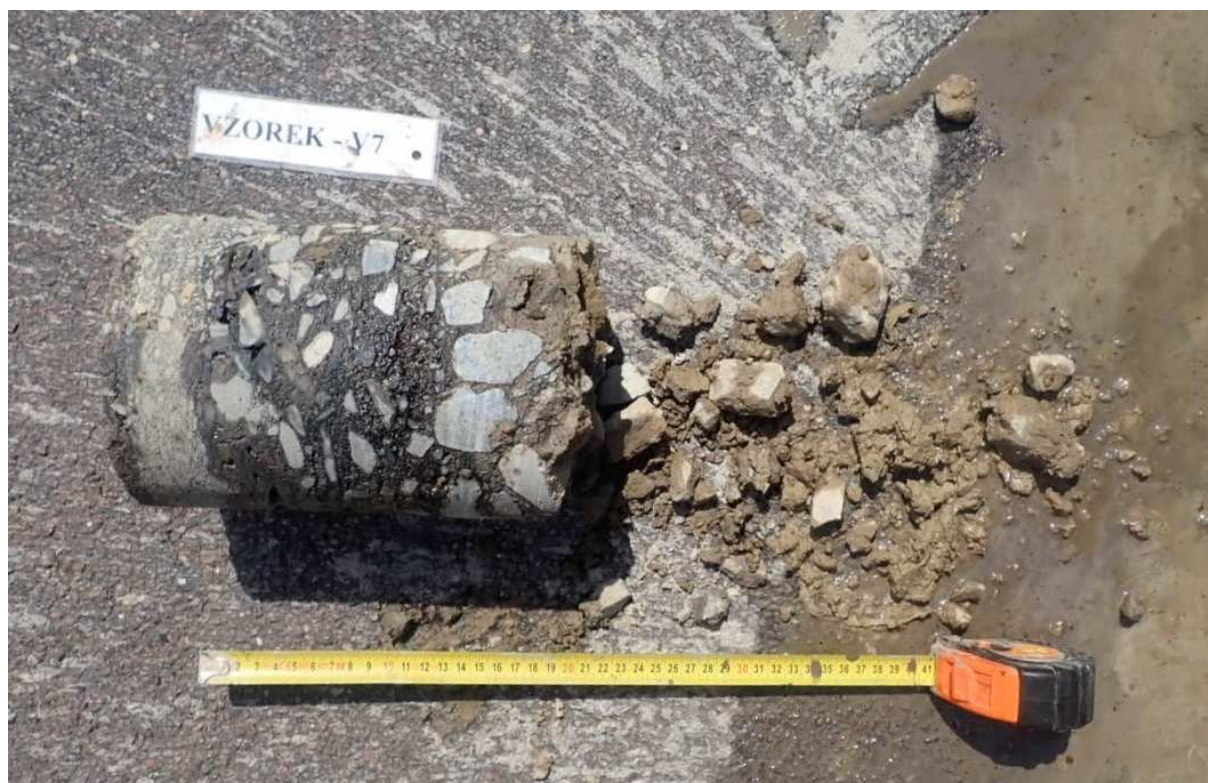
Obr. 13 - Jádro vývrtu Vzorek – V7 (in situ).
