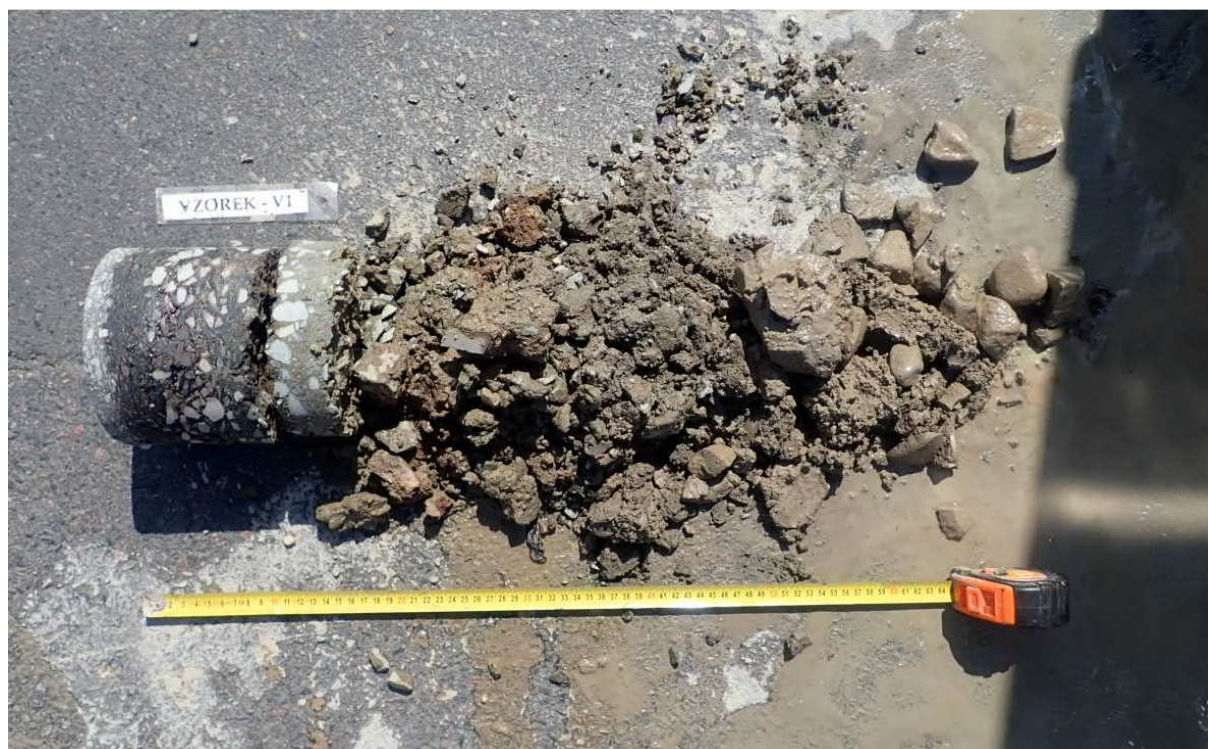
Obr. 1 - Jádru vývrtu Vzorek – V1 (in situ).
