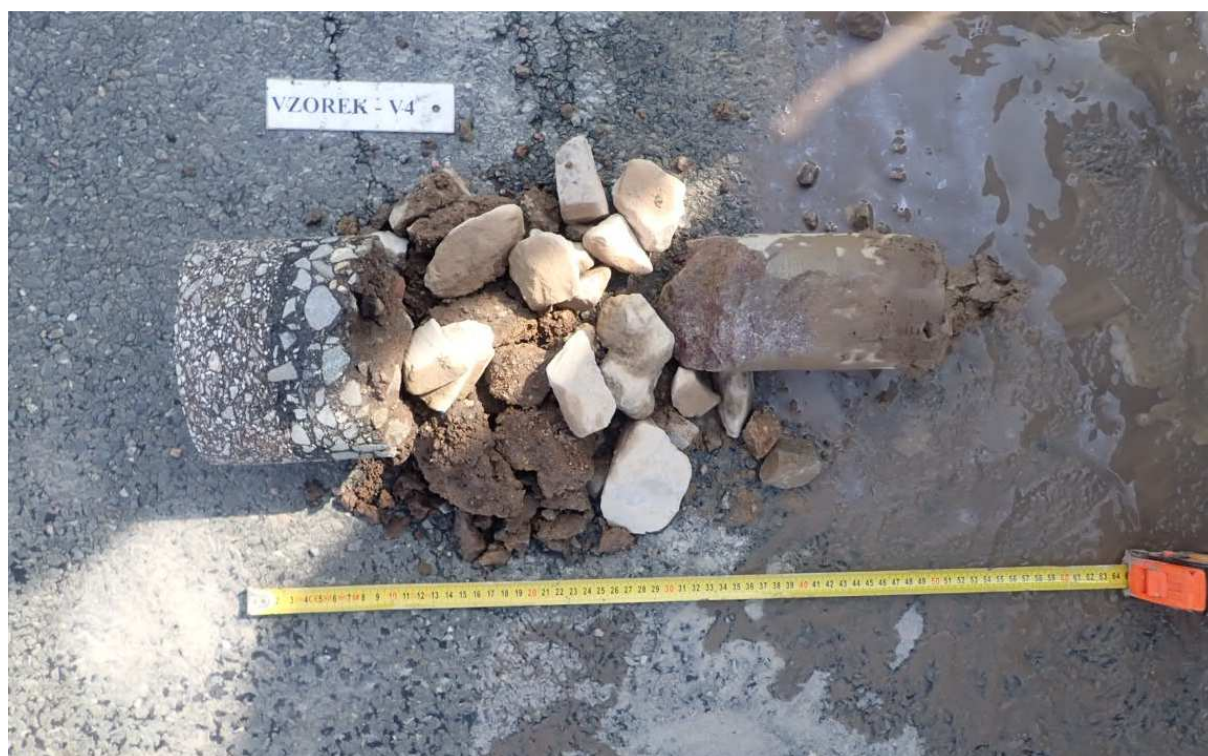
Obr. 7 - Jádvo výtvetu Vzorek – V4 (in situ).
