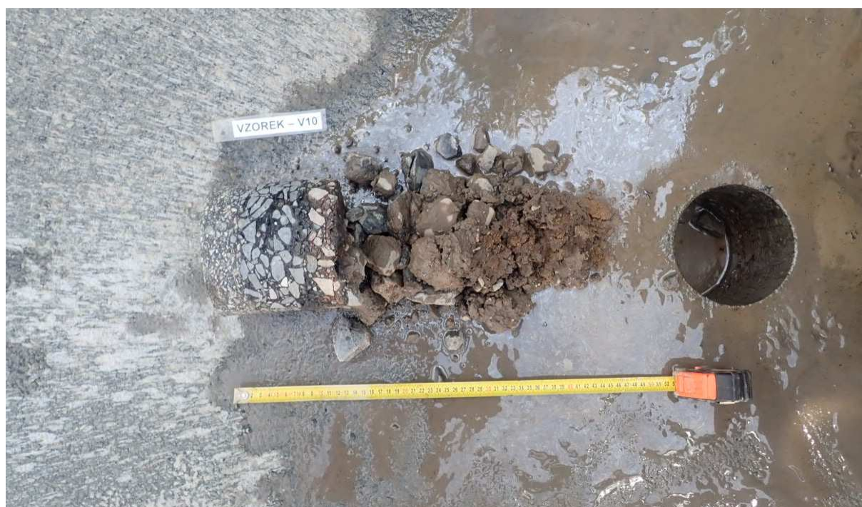
Obr. 19 - Jádro vývrtu Vzorek – V10 (in situ).
