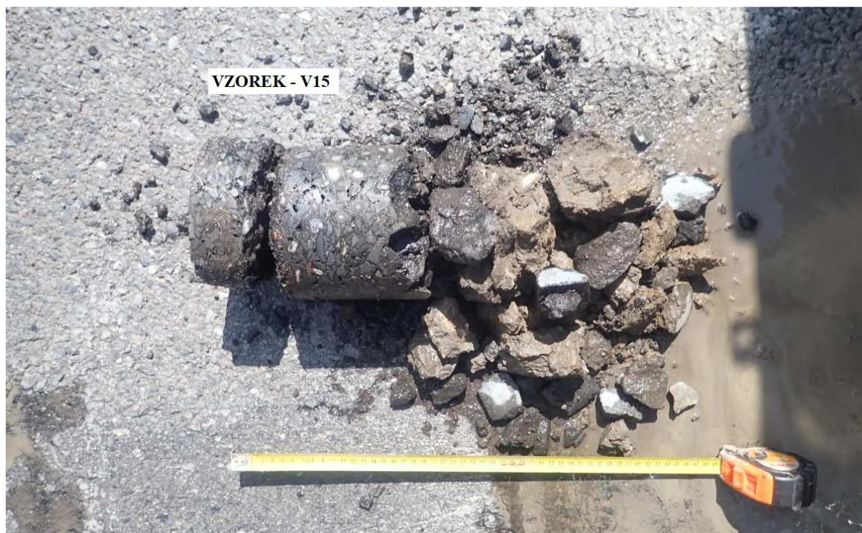
Obr. 29 - Jádro vývrtu Vzorek – V15 (in situ).
