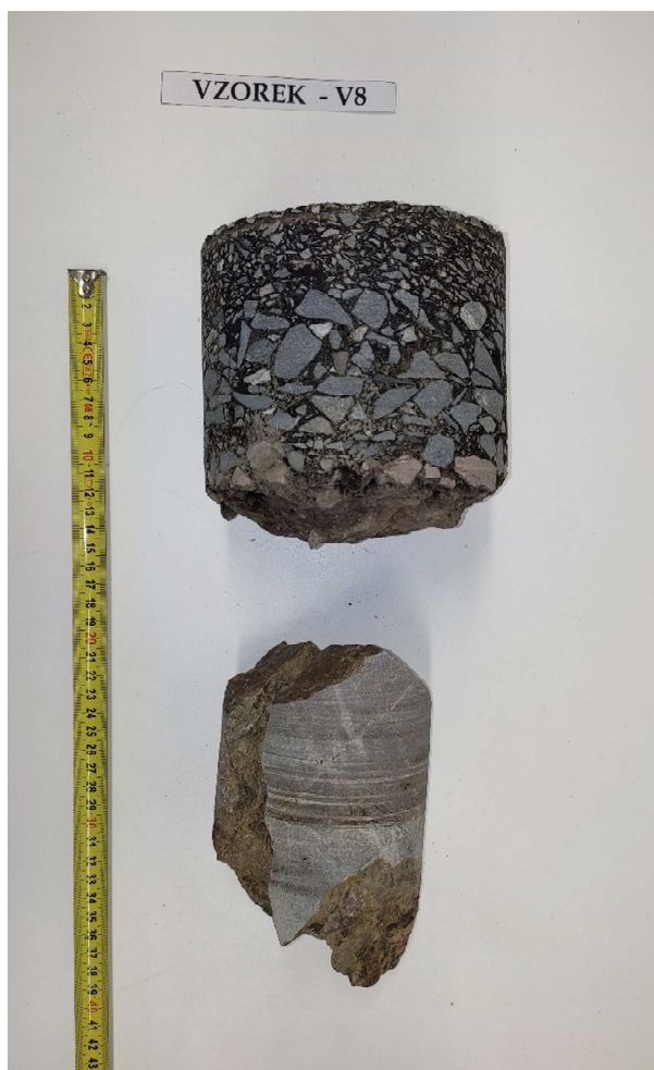
Obr. 16 - Jádro vývrtu Vzorek – V8 (laboratoř).
